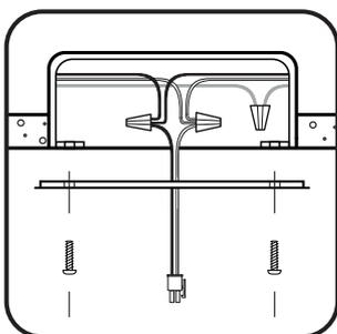
**Lorsque l'alimentation en courant alternatif est coupée**, connectez le faisceau fourni à vos lignes électriques. À l'aide des écrous orange fournis, connectez le fil noir du faisceau au(x) fil(s) noir(s) du boîtier électrique, le fil blanc du faisceau au(x) fil(s) blanc(s) du boîtier électrique. Reliez les fils rouges par un écrou ou un capuchon, comme indiqué.
